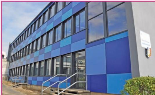
**Ecole élémentaire Ambroise Paré :** les travaux de rénovation énergétique des façades sont désormais terminés. L'école dispose maintenant d'une isolation thermique renforcée et s'est dotée de nouvelles menuiseries avec des stores intérieurs. Le bâtiment répond aux normes d'accessibilité.
